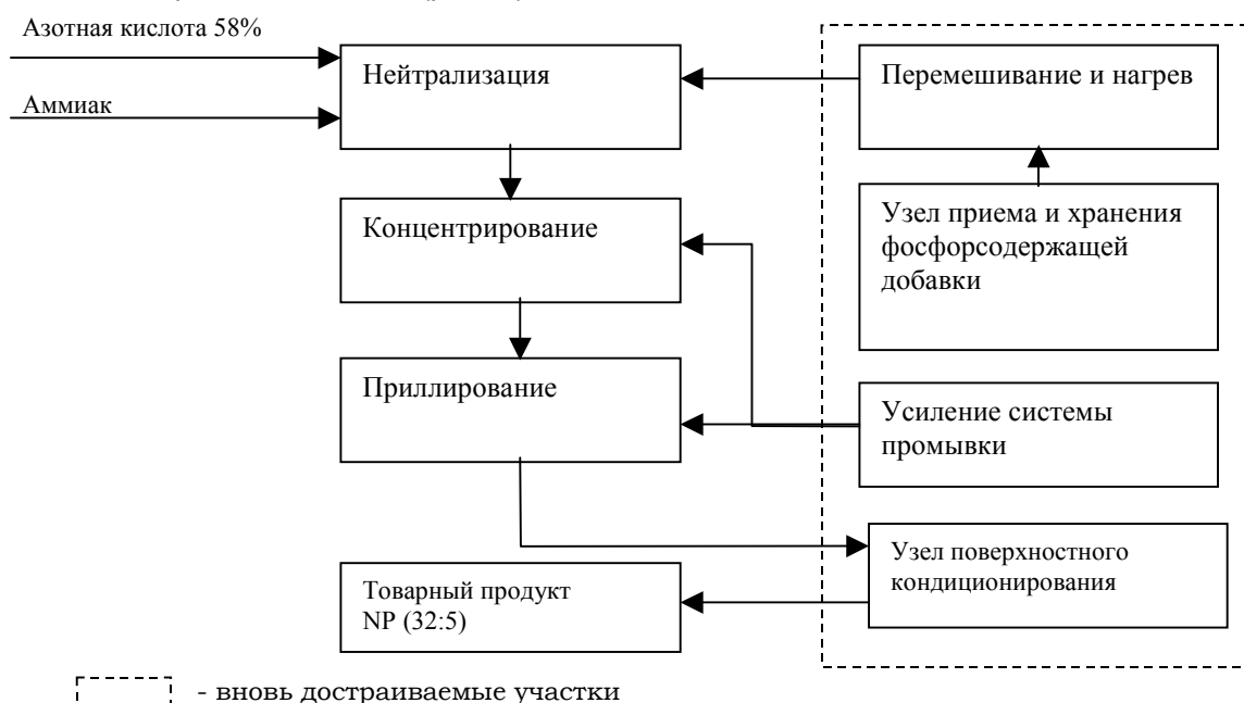
Рис. 1. Принципиальная схема производства NP-удобрения.
