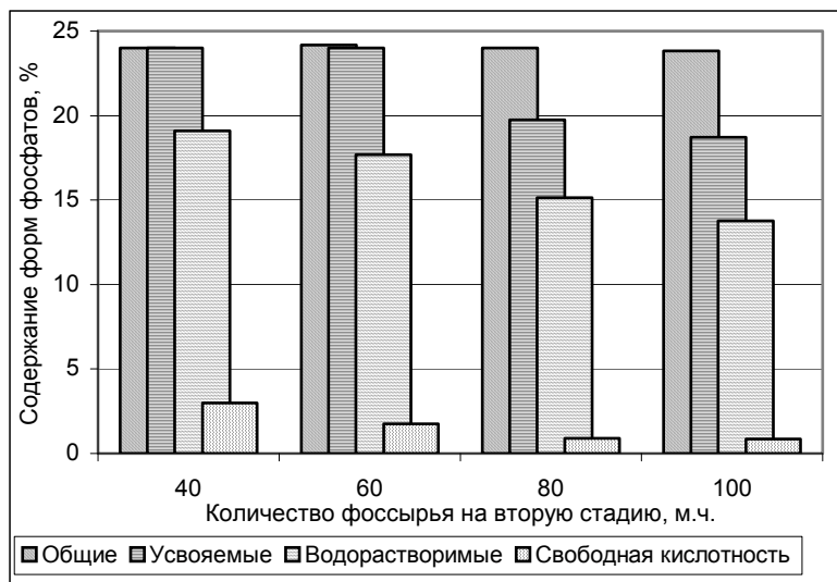
Рис. 4. Распределение форм фосфатов при разных нормах серной кислоты
